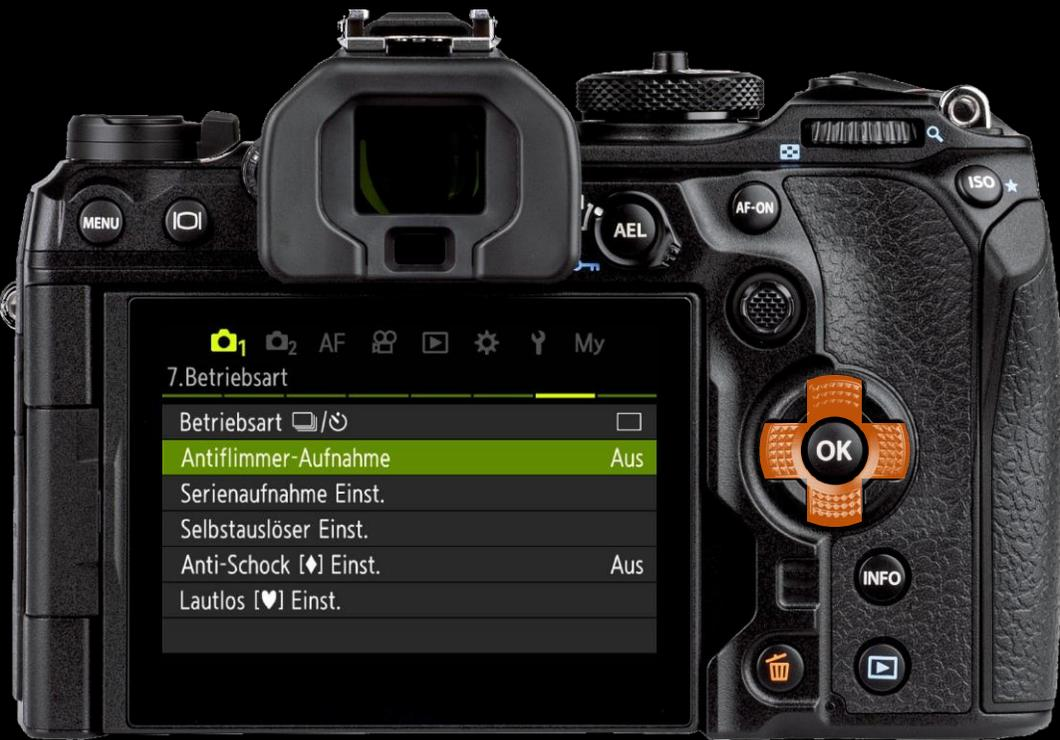
**Antiflimmer-Aufnahme** für flackernde Lichtquellen. Wenn „An“ erkennt Kamera die Frequenz und passt Zeitpunkt der Auslösung daran an.
