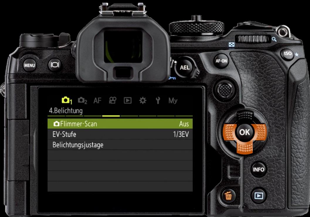
Der **Flimmer-Scan** optimiert für flackernde Lichtquellen (z.B. LED) die Verschlusszeit, um das Banding zu reduzieren – nur in M und S und nur bei elektronischem Verschluss, sonst:
