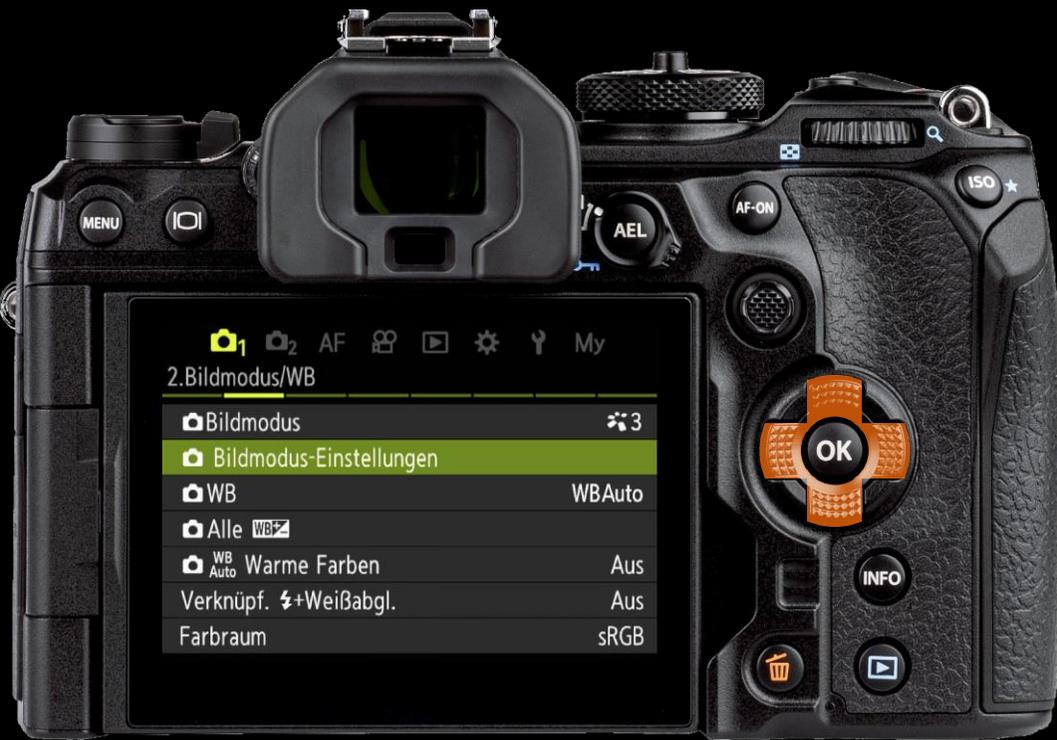
In den **Bildmodus-Einstellungen** wird ausgewählt, welche Bildmodi unter (**R1|2|1**) bzw. im **OK-Menü** angezeigt werden.
