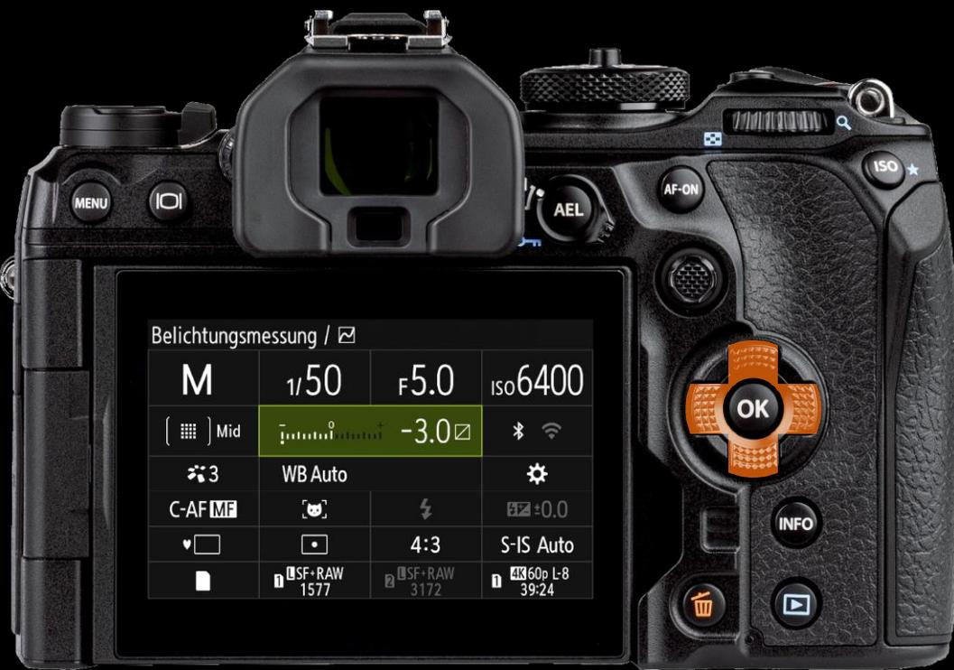
Die **Belichtungsmessung** ist eine reine Anzeige im Modus M bei ausgeschaltetem Auto-ISO. In allen anderen Aufnahmemodi (M mit Auto-ISO, P, A, S) kann man mit den Rädern die Belichtungskorrektur einstellen.
