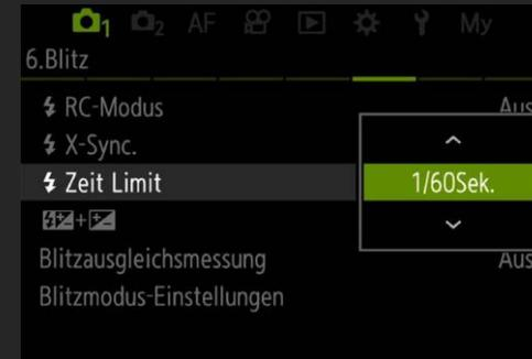
Werte einstellbar von 60s bis zum Wert, der in X-Sync eingestellt wurde für die Aufnahme-Modi P und A (also jene Modi, wo die Zeit von der Kamera automatisch eingestellt wird).
