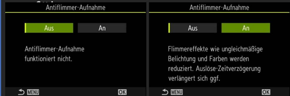
Geht nur bei kurzen Verschlusszeiten, kann die Bildfolge bei Serienaufnahmen verlangsamen. Wenn „An“ wird im Display „FLK“ angezeigt.
