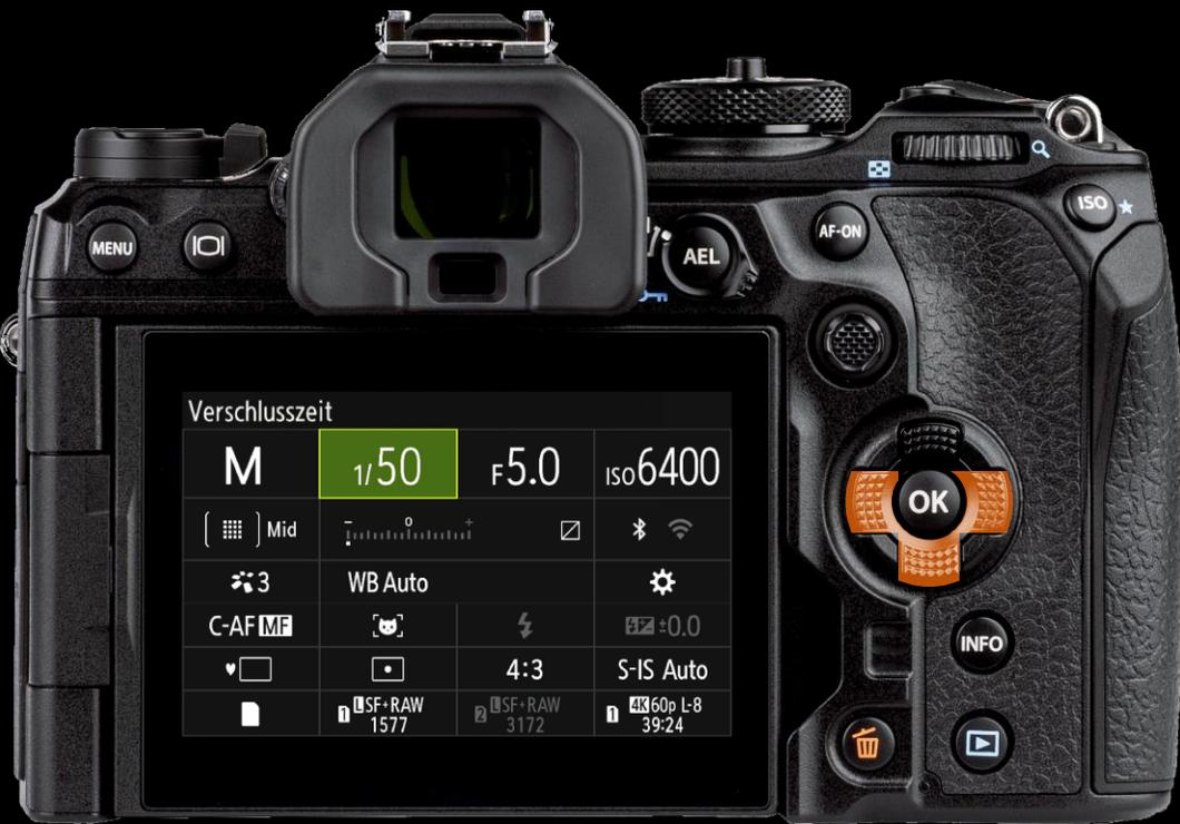
Die **Verschlusszeit** kann je nach Einstellung der Kamera mit einem der beiden Einstellräder eingestellt werden.
