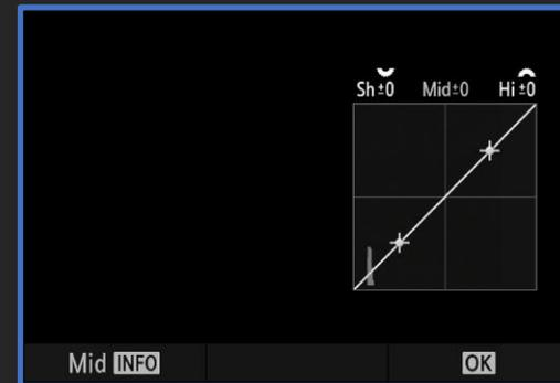
Die Gradiationskurve wird mit den Rädern und **INFO** eingestellt, bzw. mit dem Touchscreen. Die Anpassungen wirken sich nur auf JPEGs aus, nicht auf die RAW-Aufnahmen
