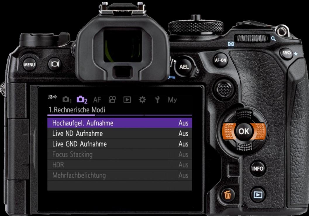
**Hochaufgelöste Aufnahme** berechnet aus mehreren Einzelaufnahmen ein Bild höherer Auflösung (als der Sensor Pixel hat)
