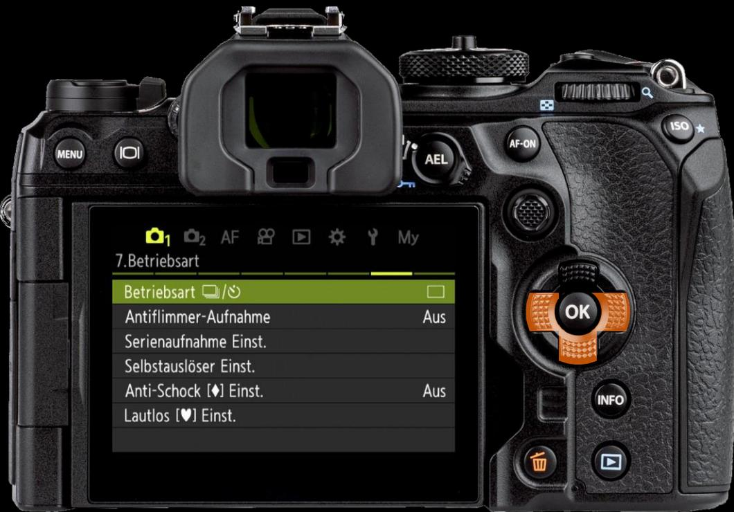
Betriebsart ist für Einzel-/Serienbild, Selbstauslöser, elektronische oder mechanische Auslösung, usw. Schneller einstellbar über OK-Menü oder auch
