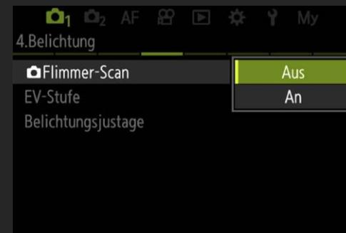
Bei „An“: Anzeige „Flicker Scan“ im Display, kein **OK-Menü** verfügbar (mit **INFO** Flimmer-Scan ausschalten) und außerdem kein Fokus-Peaking. Vgl. auch **Antiflimmer-Aufnahme**.
