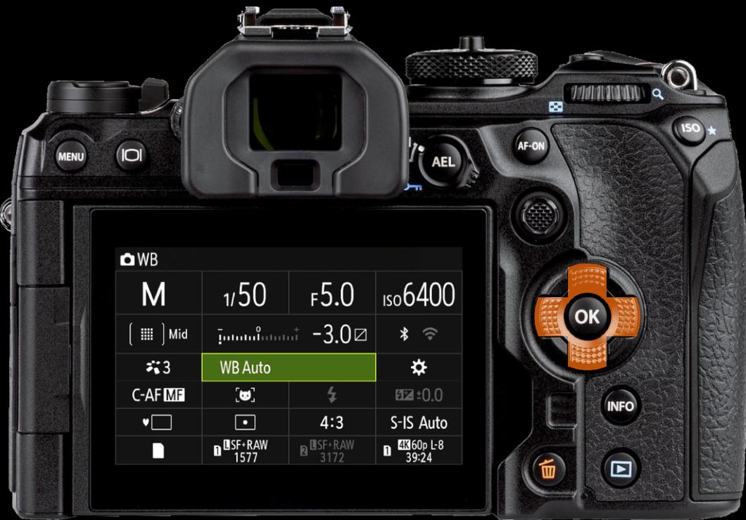
Der **Weißabgleich** (“White Balance” WB) ist v.a. bei JPEG wichtig, bei RAW kann man ihn gut im RAW-Konverter anpassen.
