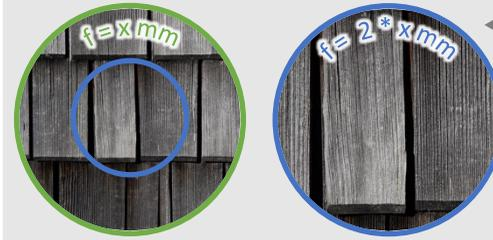
Ein Objektiv mit 2-facher Brennweite bildet einen Kreis mit halbem Durchmesser ab im Vergleich zur 1-fachen Brennweite (1/4 der Fläche\*). Diese Fläche reflektiert z.B. das Sonnenlicht zum Sensor. Andererseits ist der Durchmesser der Apertur bei 2-facher Brennweite 2 x so groß wie die Apertur bei 1-facher Brennweite (4-fache Fläche\*). Die beiden Effekte heben einander auf. Die **Brennweite spielt daher im Belichtungsdreieck keine Rolle**, sie „kürzt“ sich weg.
